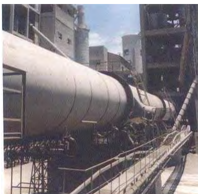
Imagen 3.3 Cocción del Clinker.
