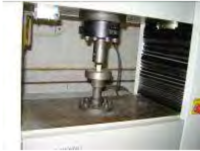
Figura 5.1 Prueba de Compresión realizada en la Máquina de Pruebas Universal SHIMADZU
