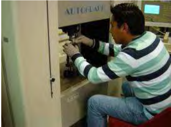
Figura 5.3 Colocación de las muestras en la Máquina Universal SHIMADZU.
