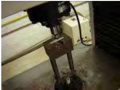
Figura 5.2 Prueba a Flexión en Tres Puntos realizada en la Máquina de Pruebas Universal SHIMADZU
