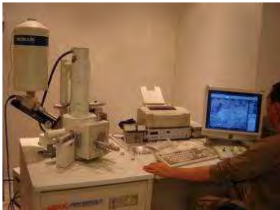
Figura 5.5 Microscopio de Barrido JEOL, en sesión de micrografías para cemento.
