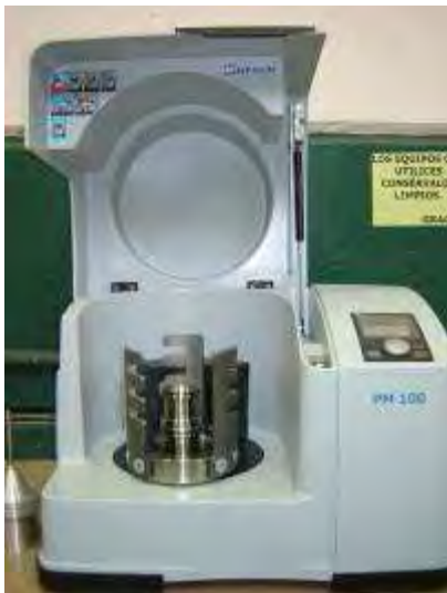
Figura 4.8 Maquina donde se efectuó la molienda de TCP con una duración de 12 Hrs.
