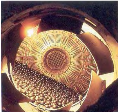
Imagen 3.4 Molienda del Clinker con diversos aditivos.
