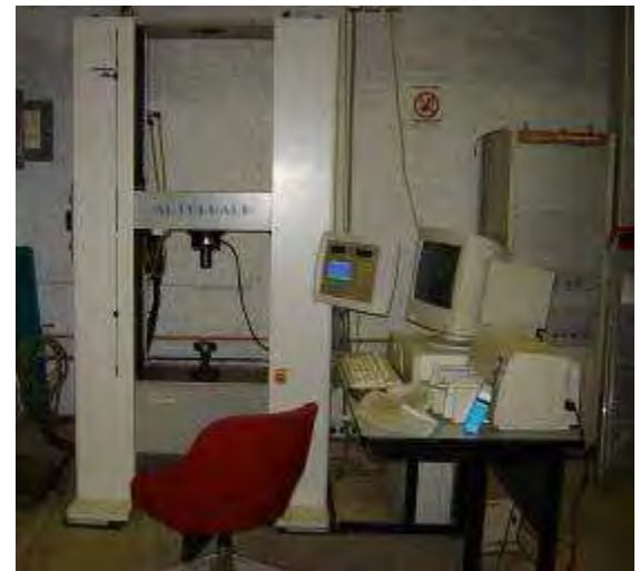
Figura 4.1 Máquina Shimadzu, Mod. AG-100 KNG. En la que se llevaron a cabo las pruebas de Compresión y Flexión en Tres Puntos, la cual se encuentra en el Instituto de Física Departamento de Estado Sólido.
