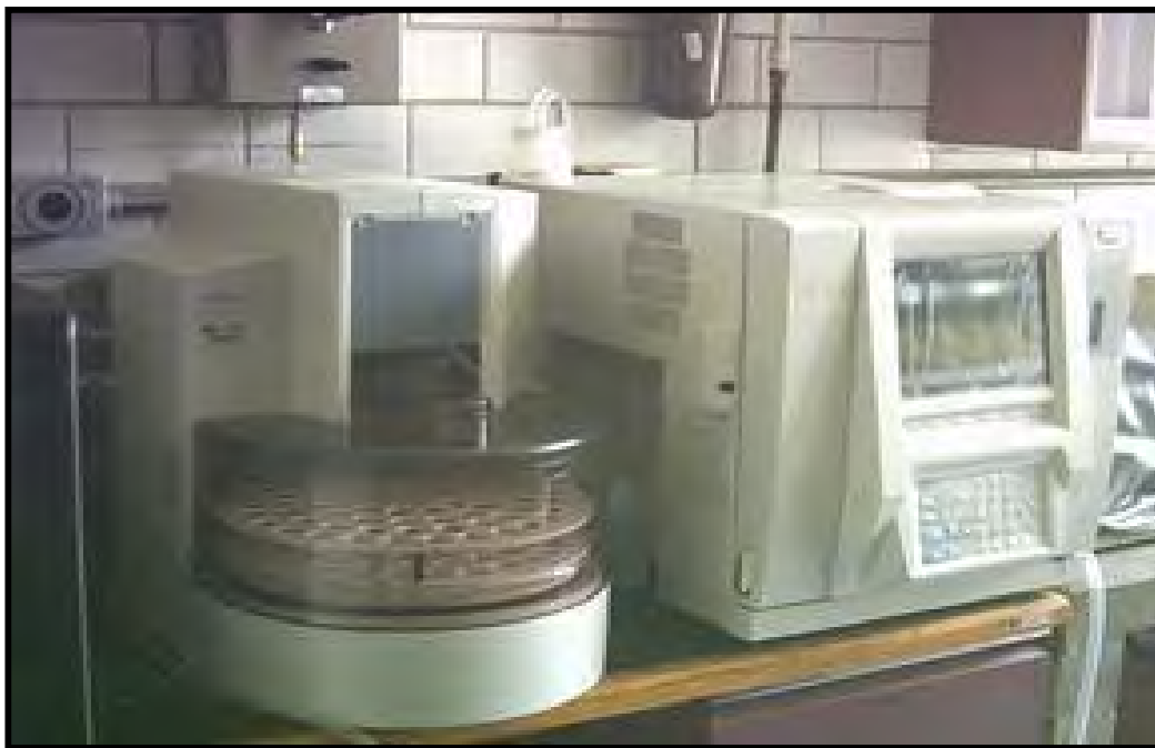
Figura 3.6 Analizador de carbono orgánico total (TOC-V CSN Shimadzu).
