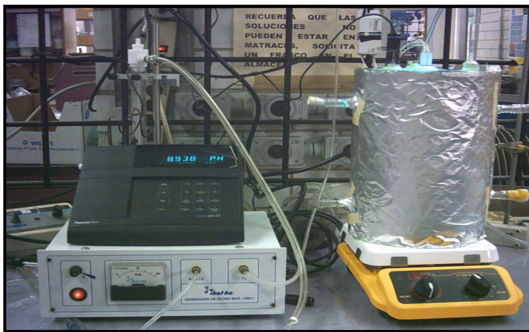
Figura 3.5 Equipo de ozonación con sistema de radiación UV.
