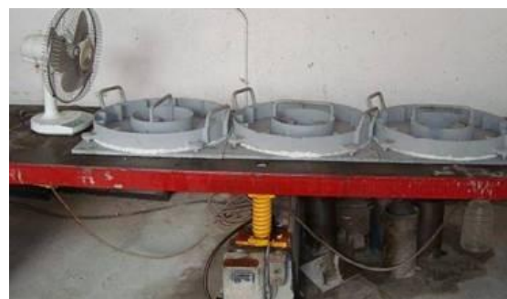
Figura 1 Molde para la prueba de contracción plástica
