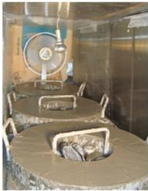
Figura 3 Configuración de la prueba de contracción plástica
