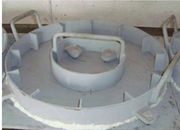
Figura 1.3 Anillo de contracción plástica
