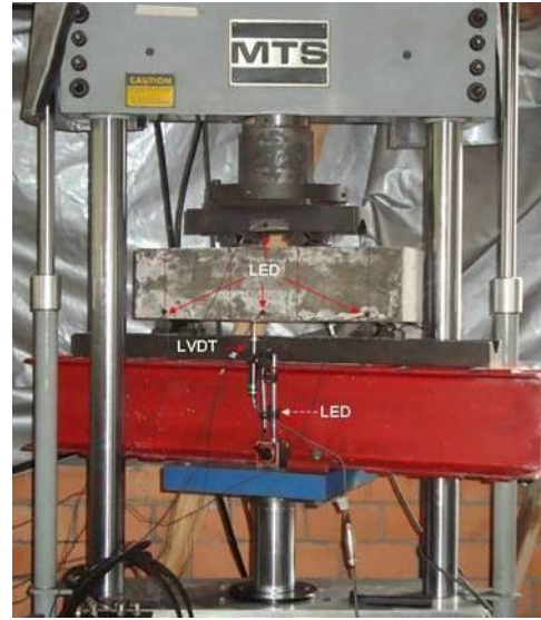
Figura 9 Configuración de la prueba de resistencia a flexión
