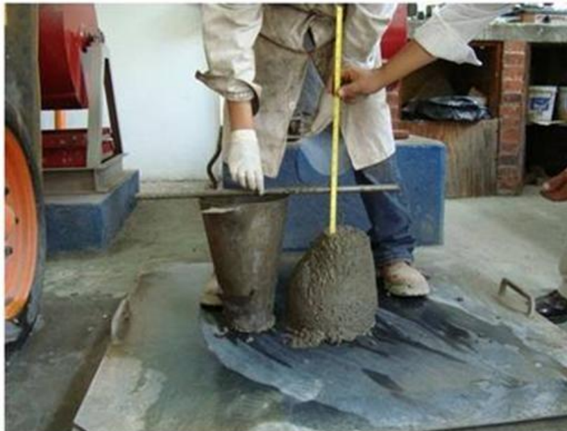
Figura 1.1 Prueba de revenimiento realizada en el laboratorio
