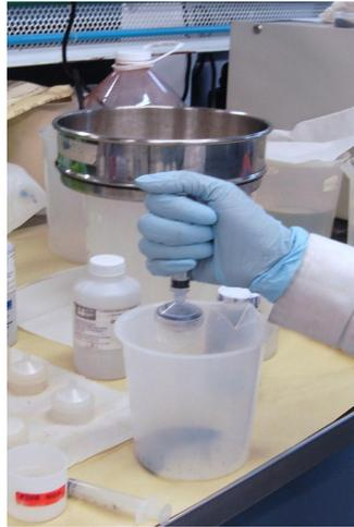
**Foto 3.13 Lavado de membranas con alcohol**
