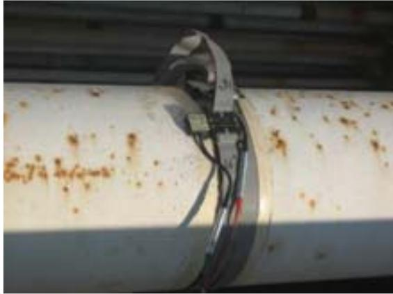
Figura 5. Embobinado para la captación de la señal de Ondas Guiadas
