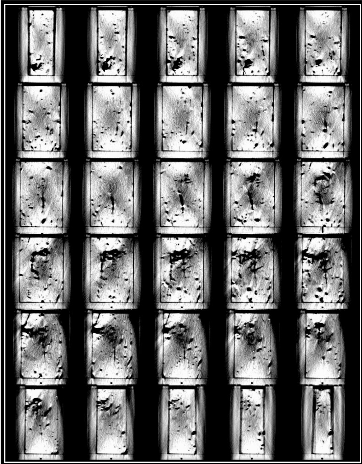
Figura 5.5b Saturación cien por ciento del Núcleo 1.
