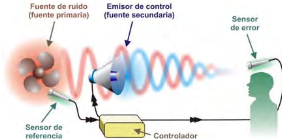
Figura 1-1: Esquema del sistema de control activo de ruido, con sus cuatro principales elementos: Sensor de error, sensor de referencia, controlador y emisor del sonido de control. Las imágenes identifican los elementos con la aplicación del presente trabajo, que es la cancelación de ruido de un ventilador.
