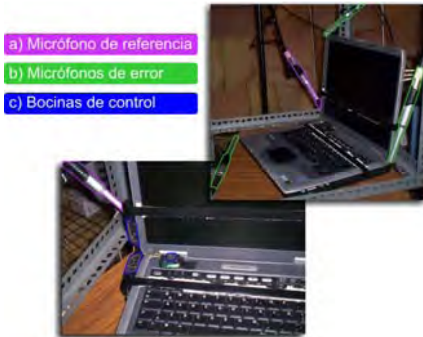
Figura 5-14: Fotografías del arreglo experimental con la localización de las bocinas de control y los micrófonos tanto de referencia como de error, ya colocados en la computadora portátil, para aproximar la configuración propuesta en las simulaciones.
