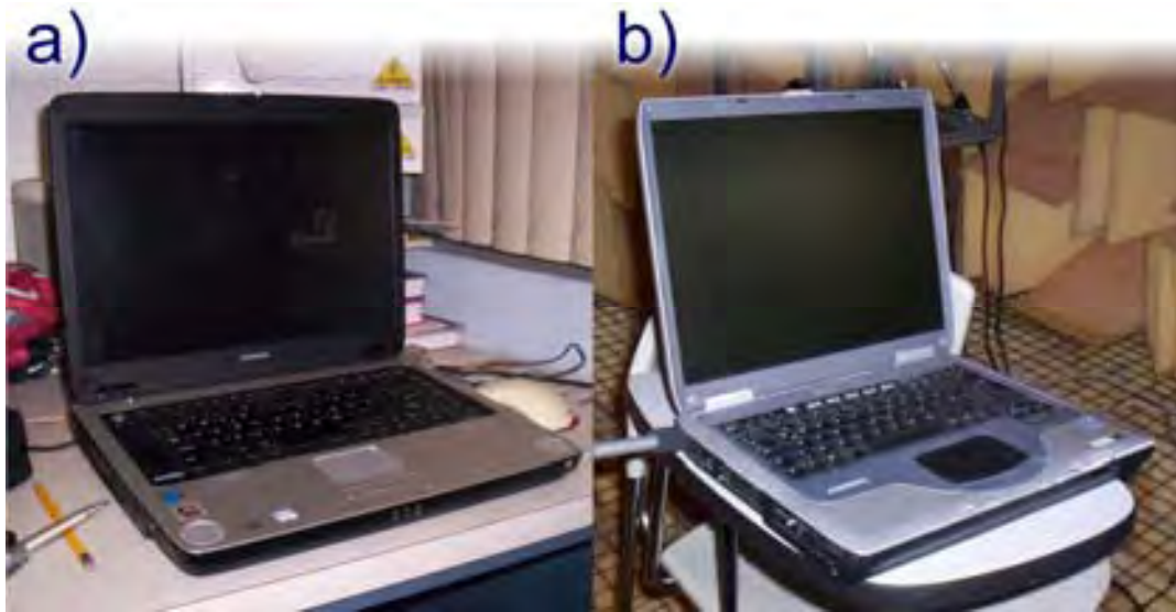
Figura 5-1: Fotografías de las dos computadoras portátiles utilizadas en las pruebas de control de un solo canal: a) la computadora 1, utilizada para ejecutar el algoritmo controlador y b) la computadora 2, usada como fuente de ruido en las pruebas de control.
