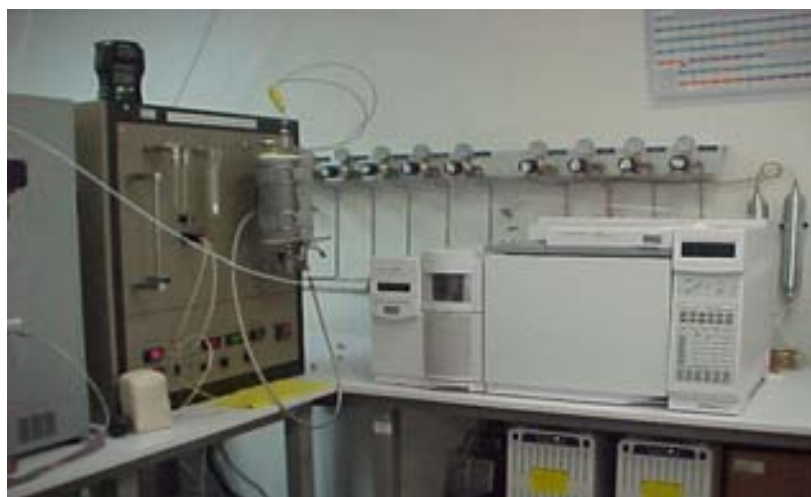
Figura 3.9. Equipo de microrreacción acoplado a la salida con el cromatógrafo de gases.
