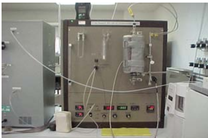
Figura 3.7. Equipo de microreacción con calentamiento.
