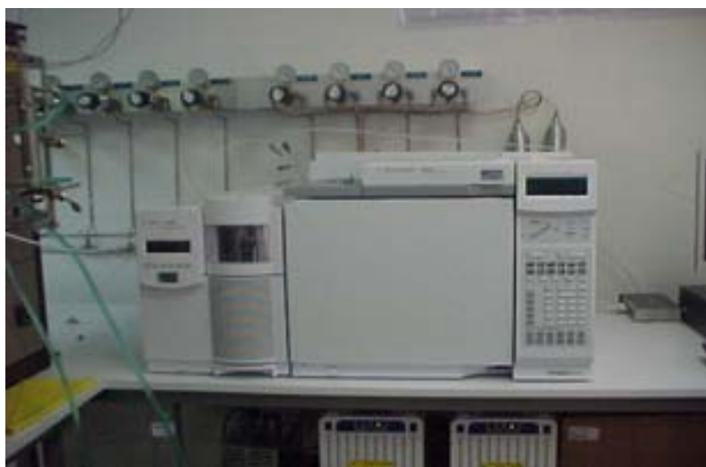
Figura 3.8. Cromatógrafo de gases empleado en el análisis de las muestras de reacción.
