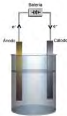
Figura 2.5.1 Electrólisis en una batería
