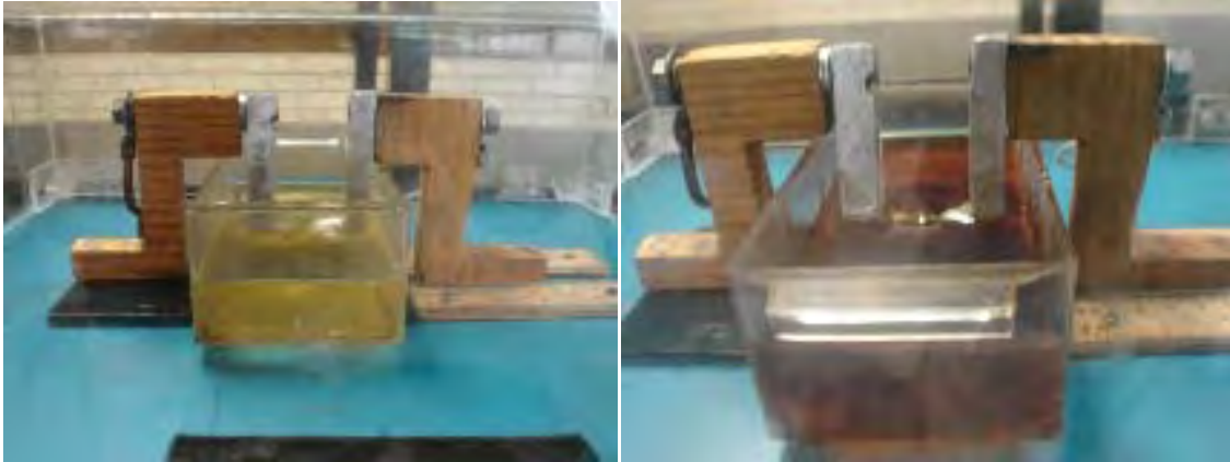
Figura 3.3.6a Ruptura de dieléctrico, aceite.
