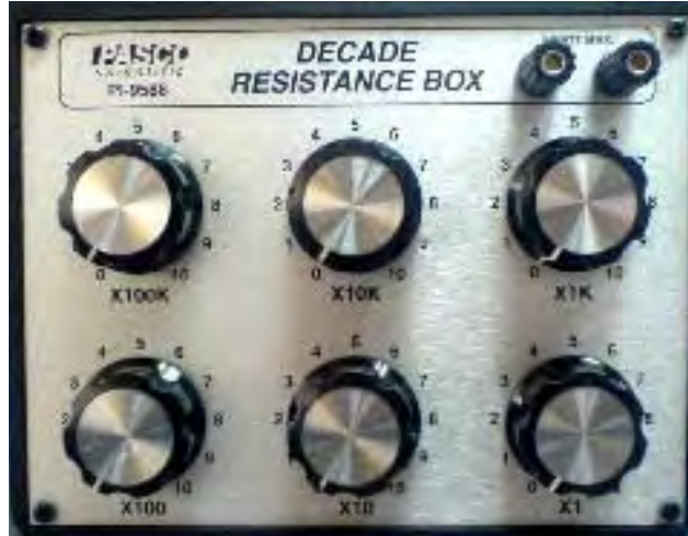
Figura 4.2.6 Modulo de resistencias por década.
