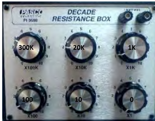
Figura 4.2.9 Ejemplo de configuración de resistencia 300K + 20K + 1K + 100 + 10 + 0 = 321.110K\Omega
