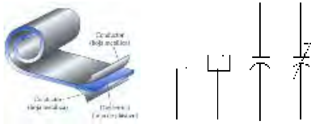
Figura 1.2.1 Constitución de un capacitor y su simbología
