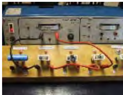
Figura 3.2.6b Capacitores en serie.
