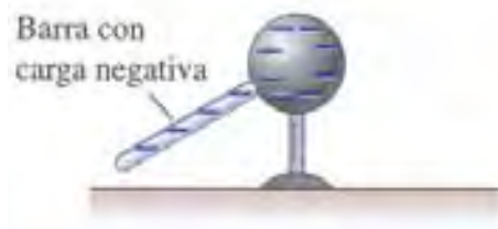
Figura 2.1.3. Carga por contacto.
