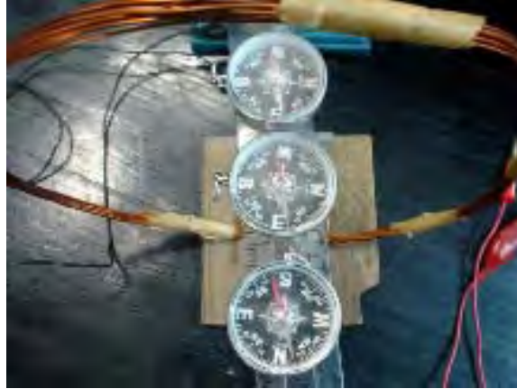
Figura 3.8.7 Las brújulas se orientan en dirección del campo magnético.
