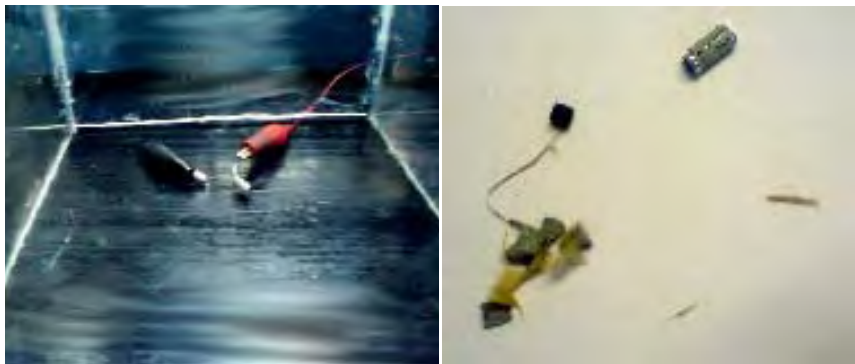
Figura 4.1.3. Prueba destructiva del capacitor.
