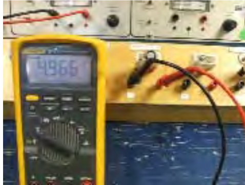
Figura 3.2.4b Desenergización de un capacitor.
