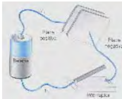
Figura 1.2.2 Capacitor cargado por una batería o fuente de fuerza electromotriz.
