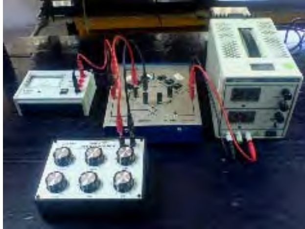
Figura 4.2.1b Puente de Wheatstone.
