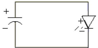
Figura 3.2.5a. Desenergización de un capacitor con LED.
