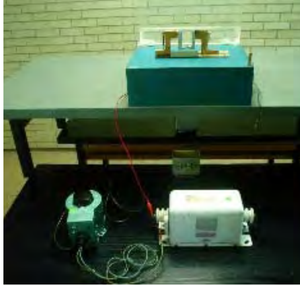
Figura 3.3.4b Dispositivo de ruptura de rigidez dieléctrica.
