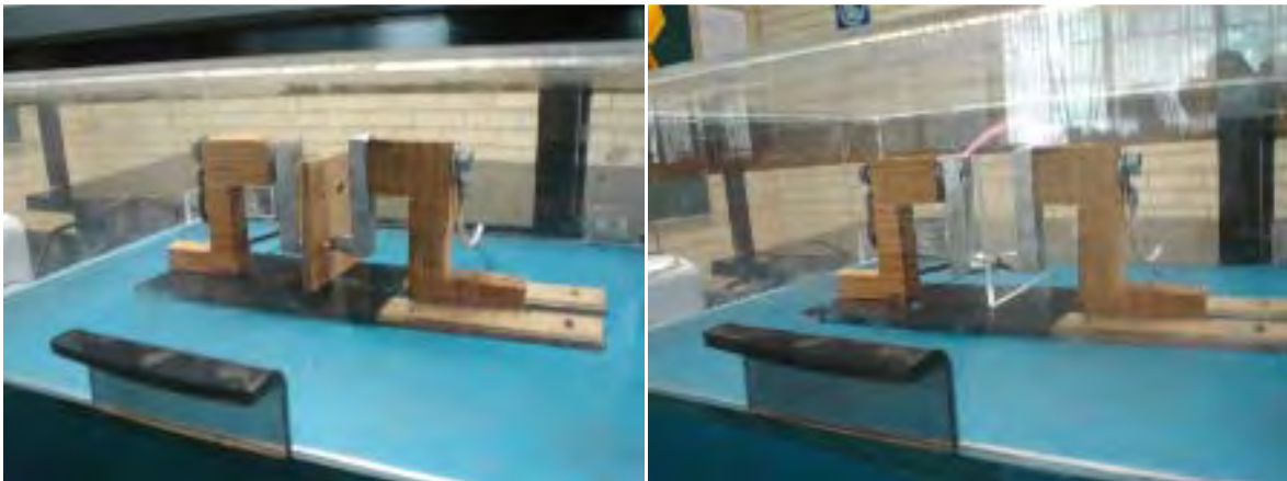
Figura 3.3.5 Ruptura de dieléctrico (madera y acrílico)
