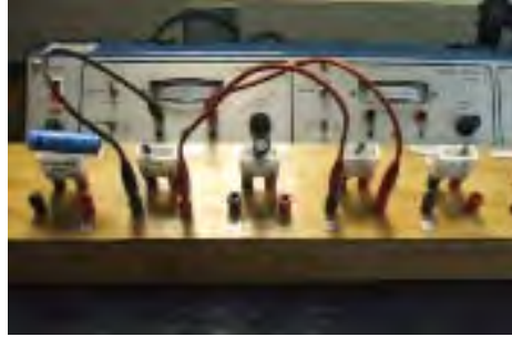
Figura 3.2.7b Capacitores en paralelo.
