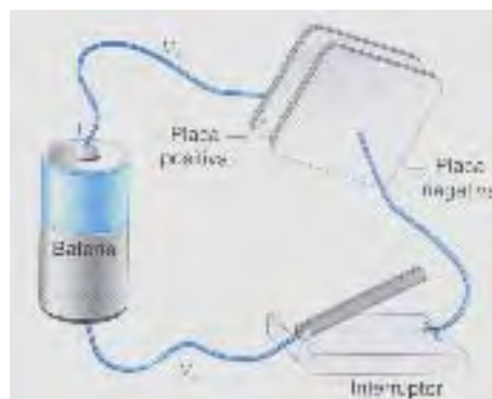
Figura 2.2.3. Principio de carga de un capacitor
