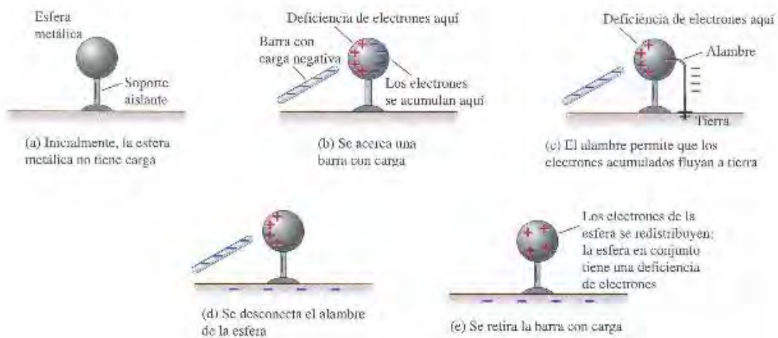
Figura 2.1.2. Carga de una esfera metálica por inducción.
