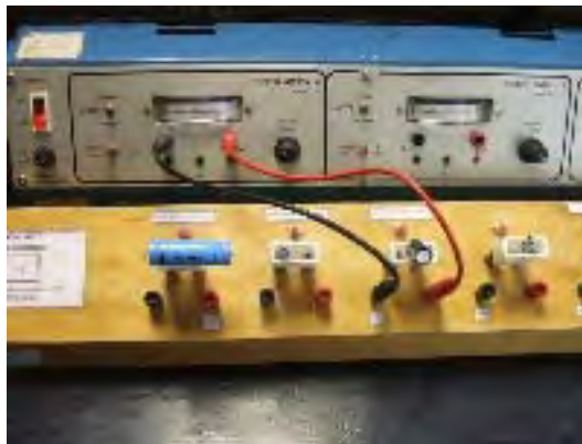
Figura 3.2.3b. Energización de un capacitor.
