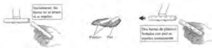
Figura 1.1.6: Forma de cargar un cuerpo por medio de frotamiento. Las barras de plástico frotadas con piel adquieren carga negativa y se repelen mutuamente.
