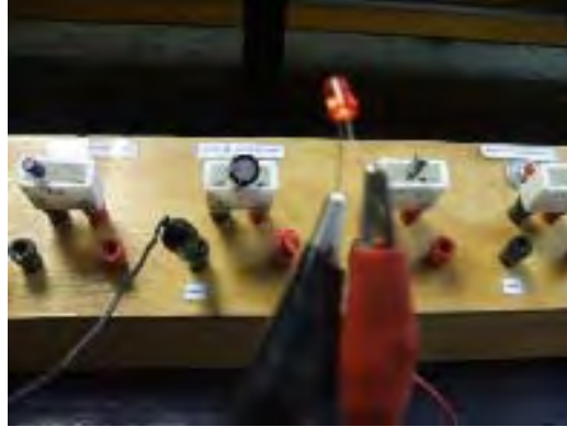
Figura 3.2.5b. Desenergización de un capacitor con LED.
