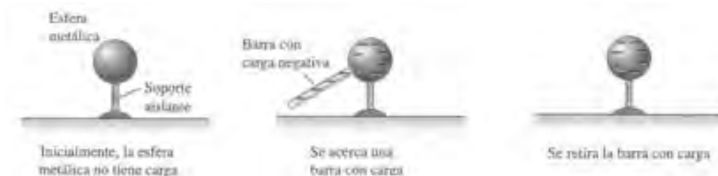
Figura 1.1.8. Carga de un cuerpo por contacto.
