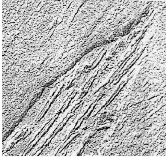
Figura 18. Con un aumento de X10000.. Muestra la Cementita aparece cuando las partículas alargadas paralelas a los listones de Ferrita. La matriz es Martensita.
