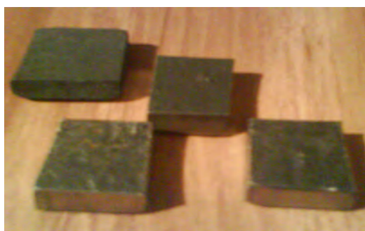
Figura 28 Muestra las probetas cortadas del acero con 5 % de Cromo.
