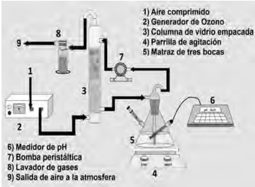
Figura 14. Diagrama experimental del sistema de ozonación de agua desfleada más peróxido de hidrógeno.
