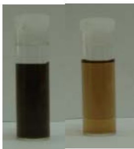
Figura 10. Coloides bimetalicos. La fotografía de la izquierda corresponde al coloide Pd(0)Ag(0), cuyo centro de nucleación, se propone que sea Ag(0). La fotografía de la derecha muestra el coloide Ag(0)Pd(0), en el que se propone al Pd(0) como centro de nucleación.
