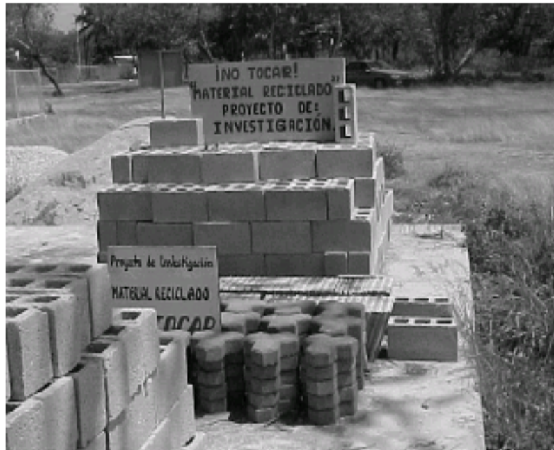
Fig., V.1.3.- Elementos constructivos reciclados.
