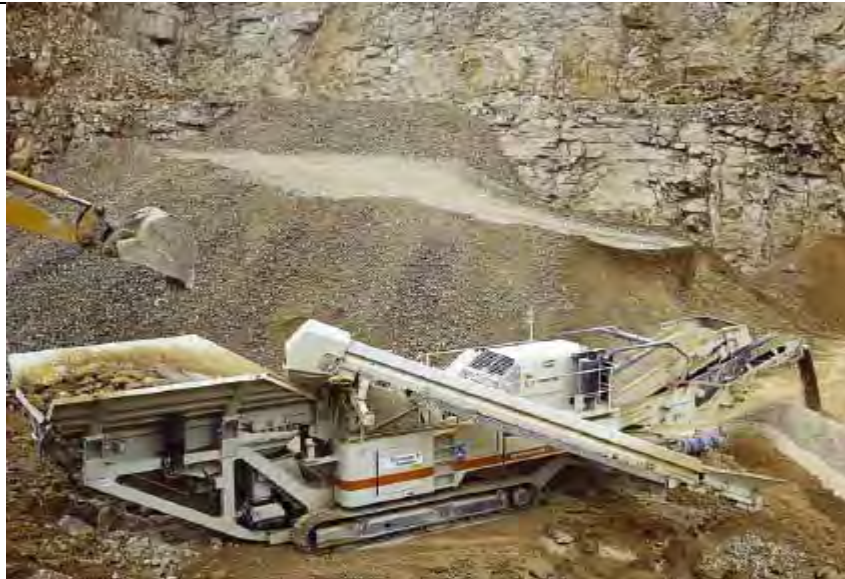
Fig. II.3.2.1.- Planta trituradora móvil ( Lokotrack LT1213S).
