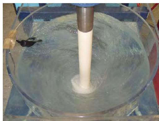
d) 573 RPM-inyección por el fondo.
