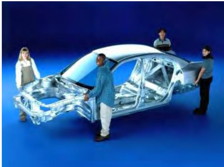
Figura 1.3 Chasis fabricado completamente de aleación de Al.
