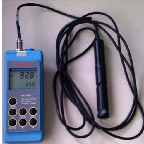
Figura 2.11. Instrumento de medición de oxígeno disuelto HANNA HI 9146.
