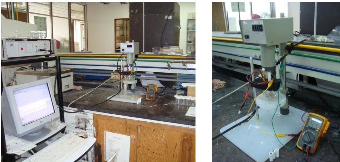
Imagen 2.1 Esta imagen muestra la disposición general del lugar de trabajo donde se realizaron las experiencias (base del electrodo de disco rotatorio, la celda electroquímica, el distanciador, el multímetro y el potencioestato - galvanoestato durante una experiencia)
