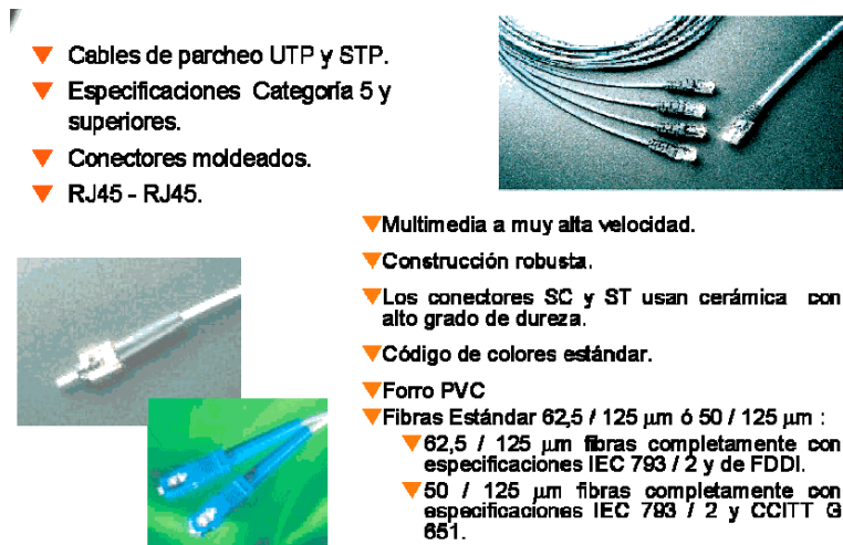
Fig. 1. 17 Cables de parcheo.
