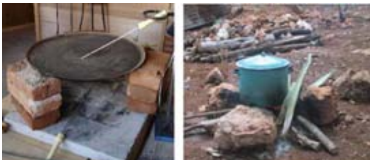
Figura 3.2: Fogón tradicional de 3 piedras, la fotografía de la izquierda fue tomada durante las pruebas experimentales en interiores, mientras que en la de la derecha se muestra en exteriores.
