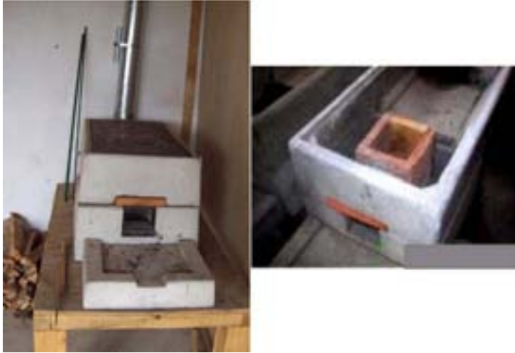
Figura 3.5: Estufa Onil, la fotografía de la izquierda muestra su exterior y la de la derecha el diseño interno.
