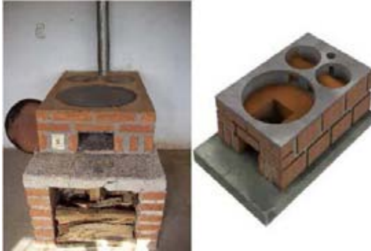
Figura 3.6: Estufa Patsari, la fotografía de la izquierda muestra su exterior y la de la derecha el diseño interno.
