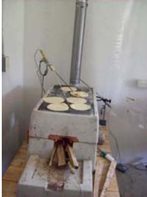
Figura 3.1: Ubicación de los termómetros en las estufas. La figura muestra como ejemplo a la estufa Onil.
