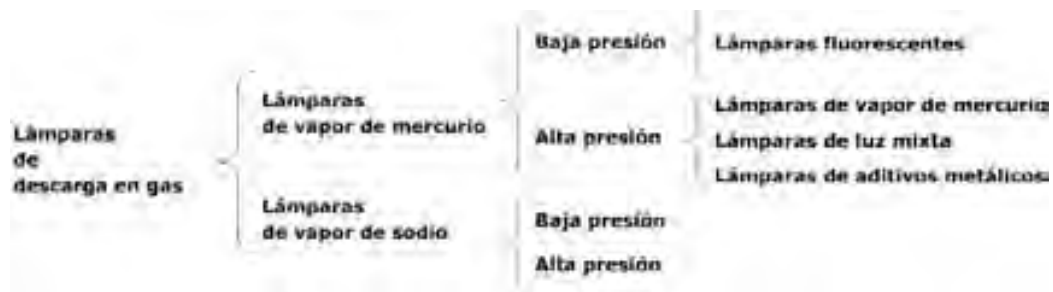
Figura 1.9 Clasificación de las lámparas de descarga en atmósfera gaseosa
