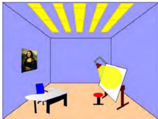
Figura 2.3 Sistema de iluminación localizada
