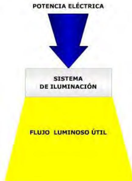
Figura 4.23 Eficacia del sistema de iluminación
