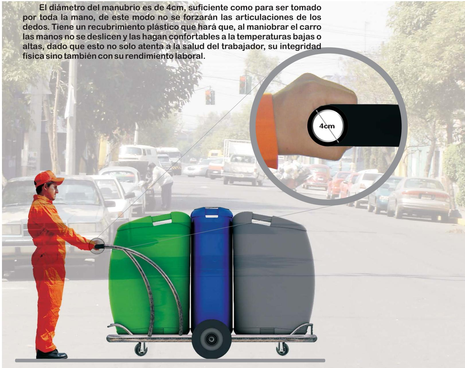
La llanta del centro es de 35cm diámetro. La resistencia a la puesta en marcha se refiere a la fuerza requerida para sacar a la rueda del estado de reposo al de movimiento. La resistencia a la rodadura se refiere a la fuerza requerida para mantener a la rueda en movimiento continuo. En ambos casos cuanto mayor sea el diámetro de la rueda, más sencillo será el movimiento de un elemento.
