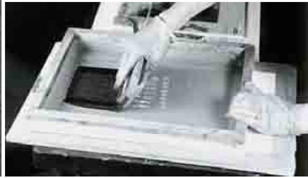
Fig. 162 Proceso de entintado con raseo sobre la malla
