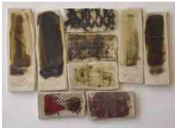
Fig. 127 Óxidos de cobre. Queman en la gama de verde-café; pero con atmósfera de reducción en el horno, se tornan color rojo-sangre oxidado.
