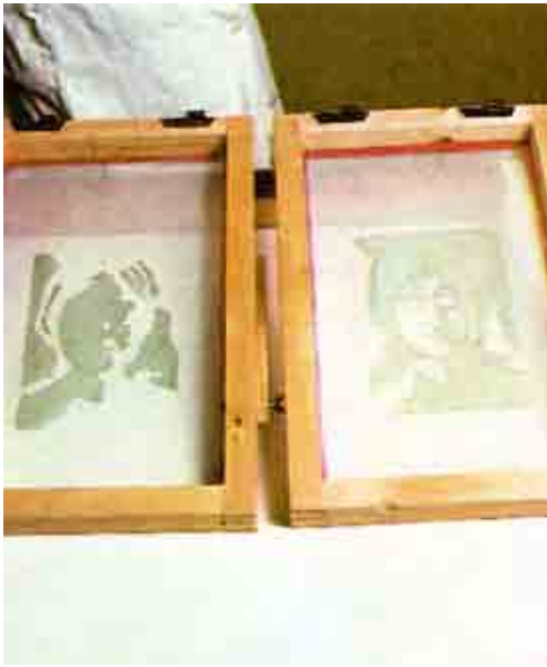
Fig. 121 Pantallas con áreas cubiertas de goma líquida
