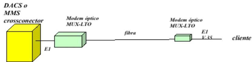
Lada enlace NX64 utilizando fibra
