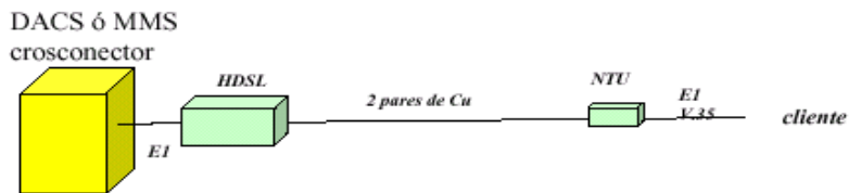
Lada enlace NX64 sin repetidor con cobre
