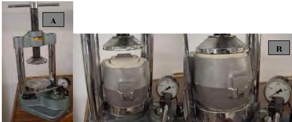
Fig. 33 **A** prensa hidráulica para uso del laboratorio dental y **B** prensado de la mufla
