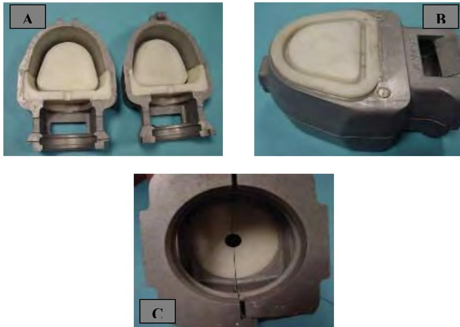
Fig. 27 Mufla para inyección de acrílico; **A** mufla y contramufla, **B** mufla cerrada y **C** orificio de entrada del acrílico
