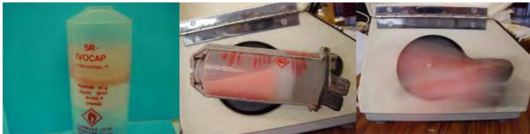
Fig. 41 Dosificación polvo-líquido de acrílico termopolimerizable mezclado en un vibrador por 5 min.
