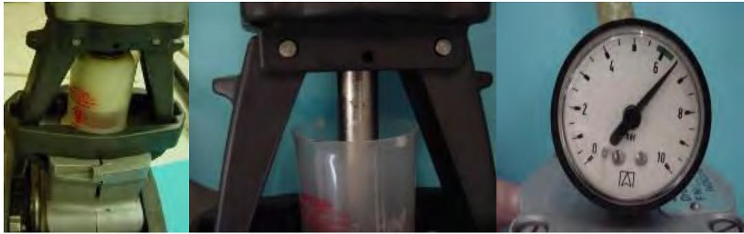
Fig. 42 Acoplamiento cápsula – inyector – brida, inyectando material acrílico a presión constante
