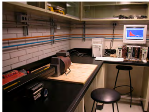
Fig.3.6 Experimento, al fondo se observa el ordenador con un espectro. Al frente, el láser y el primer colimador dentro del cual se encuentra la fuente de ^{137}\text{Cs}
