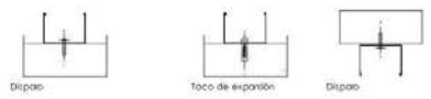
FIJACIÓN DE CANAL AL SUELO SOBRE MATERIALES PÉTREOS O LOSA DE CONCRETO
