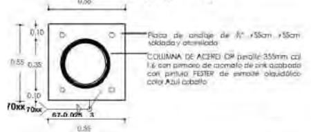
Placa de Anclaje (planta)
