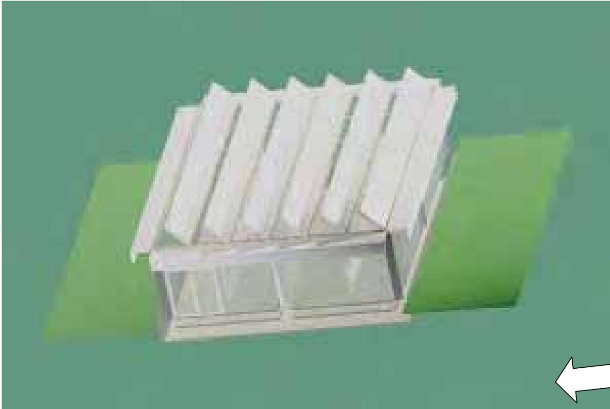
En derivación de los estudios anteriores se considera necesario agregar un diseño de parasoles en serie cubriendo la totalidad de la superficie de la techumbre logrando un control mas optimo de la incidencia solar hacia el interior de la galería desde la parte superior.
