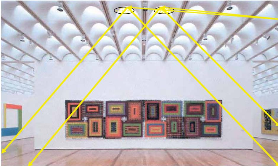
Un excelente ejemplo de topología bioclimática en la cubierta de esta galería en forma de acasetonamientos hiperbólicos se logra una retícula de claraboyas ideal para un manto lumínico de iluminación natural indirecta.
