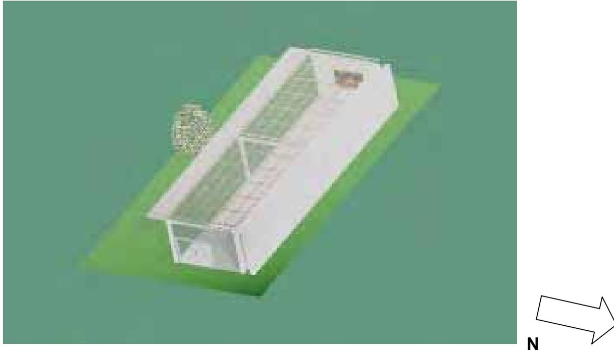
Debido a la gran incidencia de luz solar sobre la fachada sur se consideró un muro Trombe para aislamiento térmico de la envolvente principal de exhibición.
