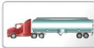
CAJA CISTERNA O TANQUE
