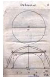
Trazo de bóveda vaída, en Juan de Torija (1661:F.8). FR-BNM: Raros y Curiosos R 729.33F TOR.b. Digitalización: BNM.
