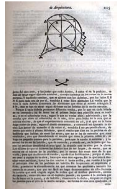
Método para el trazo de pechinas, publicado en fray Lorenzo de San Nicolás (1663:F.105). FR-BNM: Raros y Curiosos R 720 F SANA. Digitalización: BNM.
