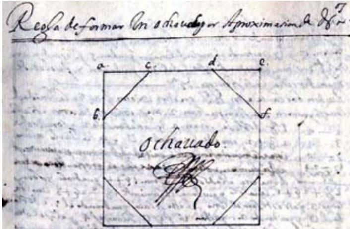
Regla para formar un ochavado por aproximación de números, según fray Diego Rodríguez (siglo XVII:F.16f). FR-BNM: Ms. 1519. Digitalización: BNM.
