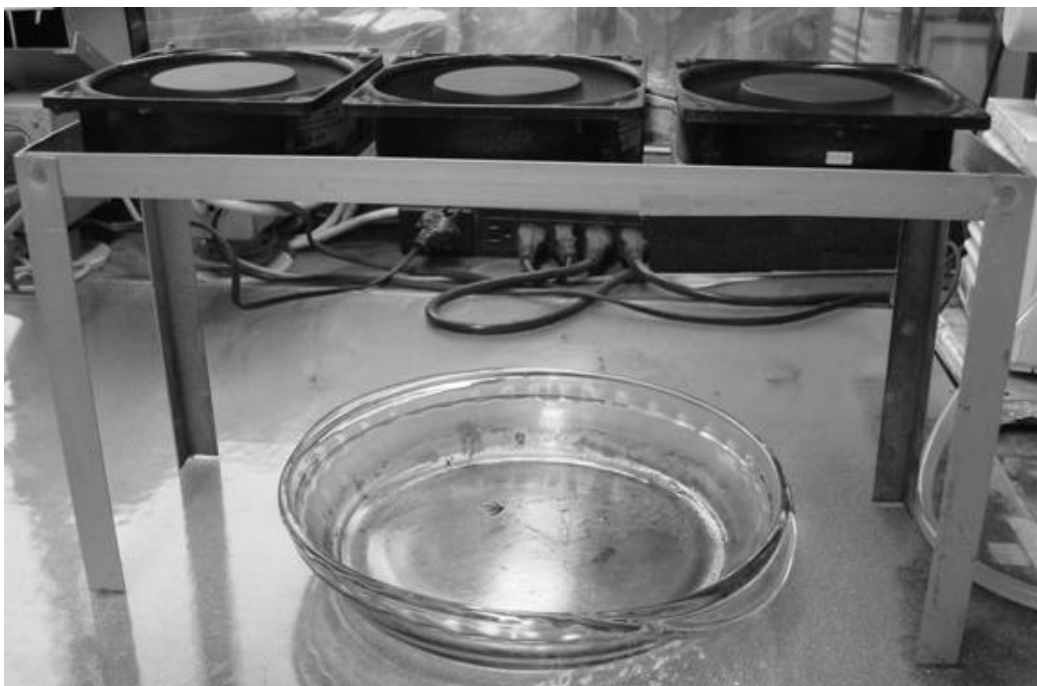
Figura 11. Dispositivo diseñado en el laboratorio para acelerar la evaporación de los disolventes
