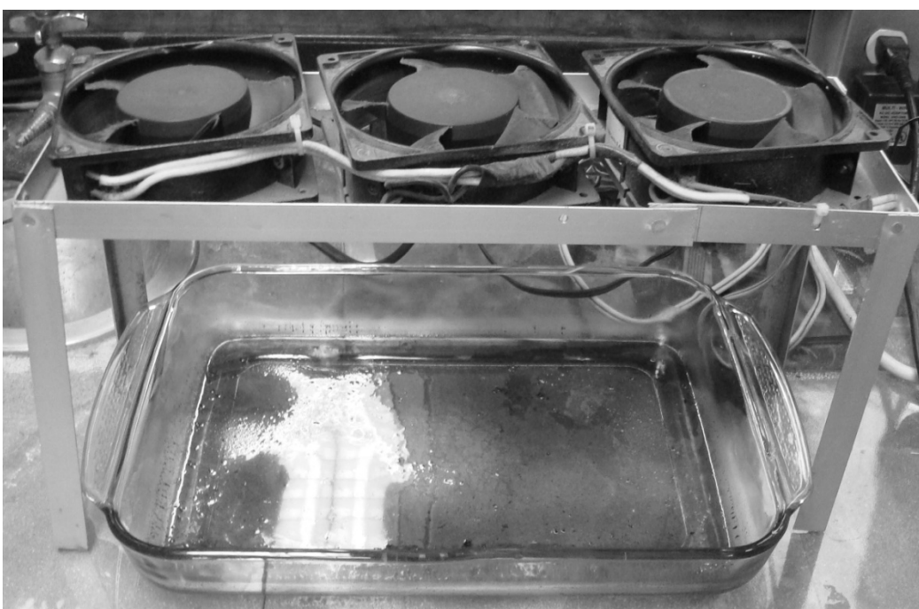
Figura 12. Dispositivo diseñado en el laboratorio para acelerar la evaporación de los disolventes
