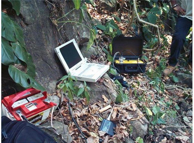
Sismógrafo Seistonix Ras-24, empleado durante la toma de registros sísmicos
