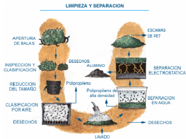
Figura 2.11 Pasos del Proceso para el Reciclado Mecánico (APREPET)
