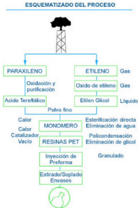
Figura 2.4 Proceso de elaboración de envases PET. Fuente: APREPET, 2006.
