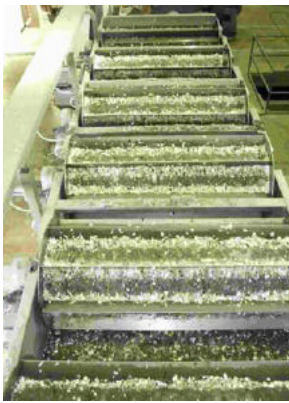
Figura 3.7 a) Equipo de separación por burbujeo Figura 3.7 b) Equipo de flotación con banda transportadora
