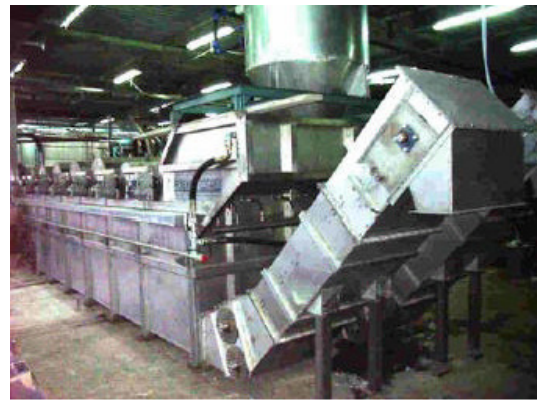
Figura 3.7 a) Equipo de separación por burbujeo Figura 3.7 b) Equipo de flotación con banda transportadora
