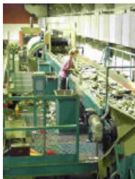
Figura 3.6 Banda Transportadora para separación manual de materia prima
