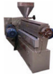
Figura 3.11 b) "Dado" Máquina para dar forma al PET (extrusión)
