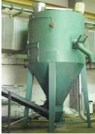
Figura 3.8 Hidrociclón par la limpieza del PET
