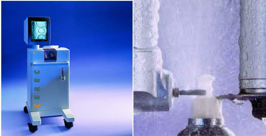
Figura 8. CEREC II, fresa diamantada cilíndrica trabajando conjuntamente con el disco.<sup>17,36</sup>
