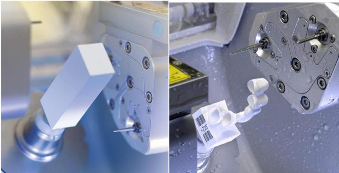
Figura 13. Elaboración de una prótesis de 6 unidades.<sup>44</sup>
