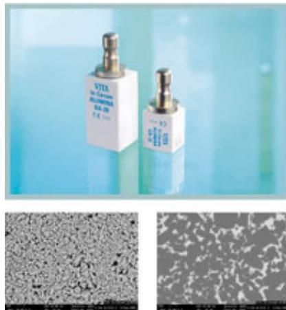
Figura 25. Alta translucidez. Microestructura porosa (izquierda) y de vidrio infiltrado (figura de la derecha) estado a más de 10.000 veces de aumento<sup>5</sup>.
