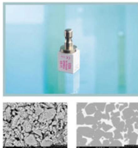
Figura 24. Con muy alta translucidez. Microestructura porosa (izquierda) y de vidrio infiltrado (figura de la derecha) estado a más de 10.000 veces de aumento <sup>5</sup>.
