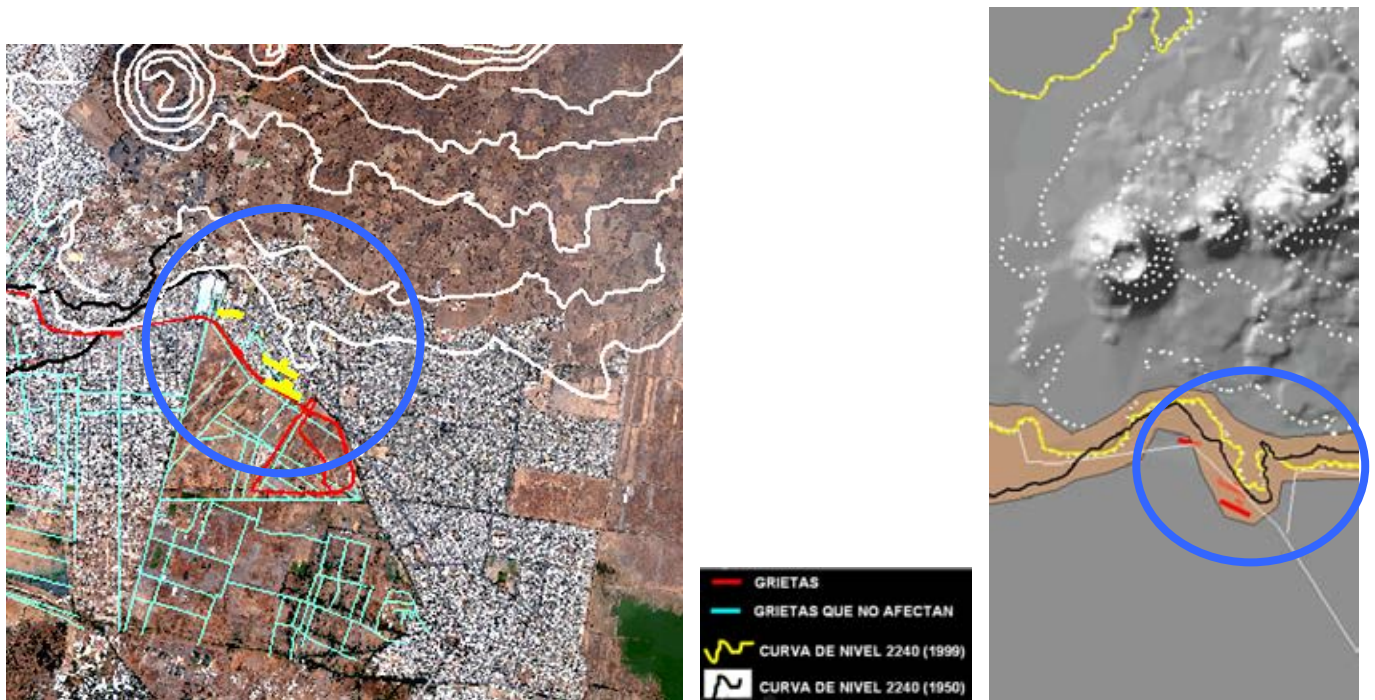
Fig. 2.29 Grietas Loma de Tlaltenco
