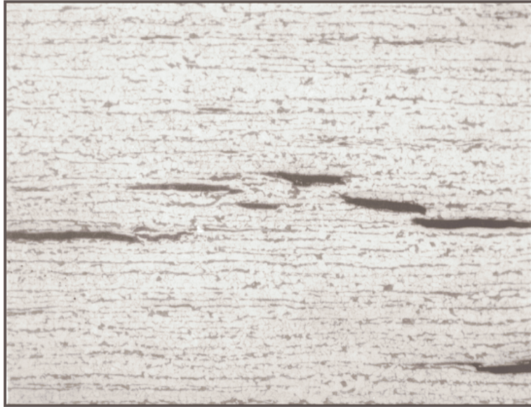
Figura 3.8. Agrietamiento escalonado inducido por hidrógeno (200 X).
