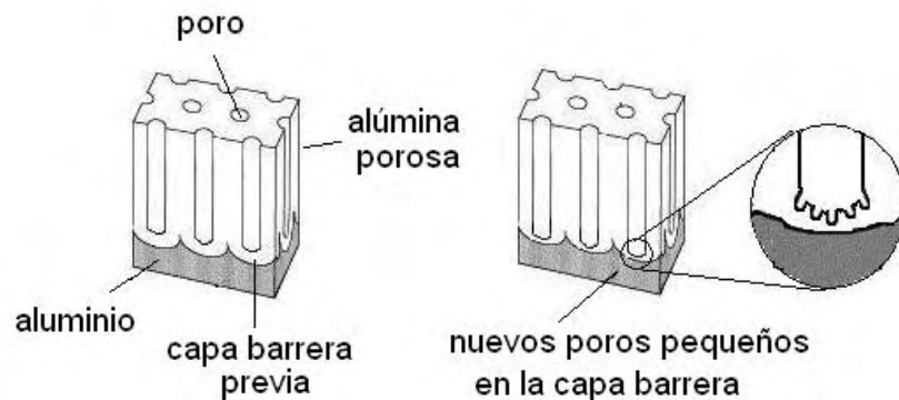
Figura 23. Capa barrera adelgazada por la técnica de secuencia de reducción de voltaje. El diámetro de los poros se conserva con este proceso.
