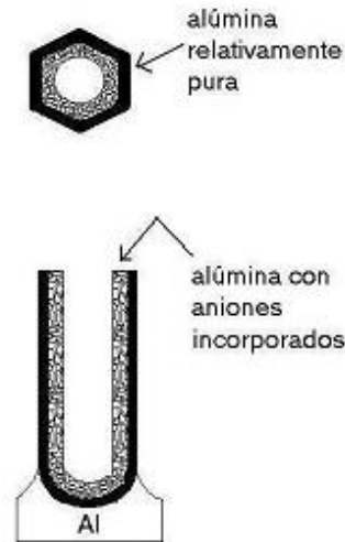
Figura 4. Estructura de las celdas de óxido de aluminio anódico. La zona sombreada comprende la película de material contaminado con aniones ácidos adyacente al poro y la zona más oscura corresponde a óxido de aluminio libre de aniones.
