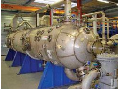
Fig. 1.9 Separador submarino, diseñado por FMC y CDS Engineering en colaboración con Statoil. 23
