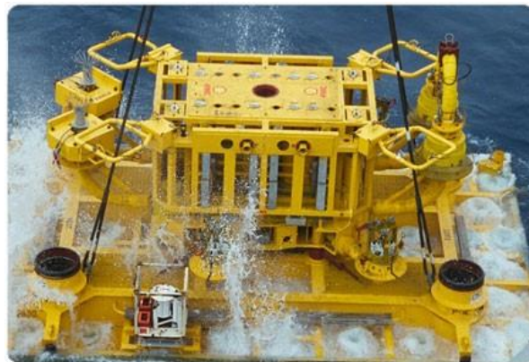
Fig. 1.16 Módulo de Múltiples de Válvulas. 38
