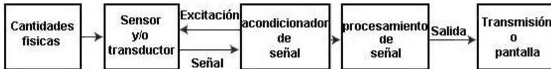
Figura 2.1. Diagrama a bloques de un Sistema de Instrumentación.
