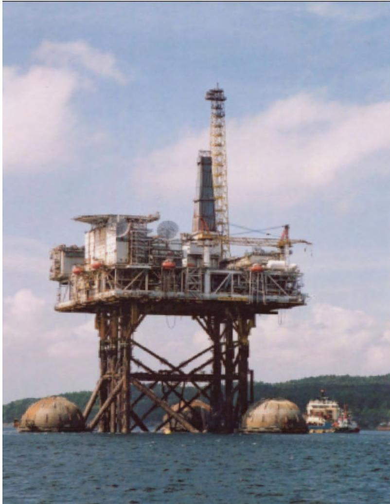
Figura 5.6-4 Plataforma Maureen reflatada y remolcada hacia una nueva localización. (Tomado de Oilfield Review, Schlumberger<sup>30</sup>, 2007).
