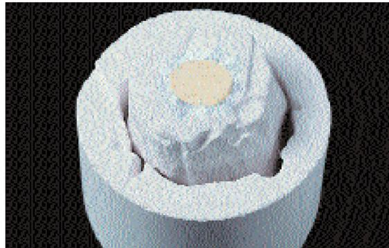
Al eliminar el revestimiento, posteriormente se va a arenar en la dirección indicada.
