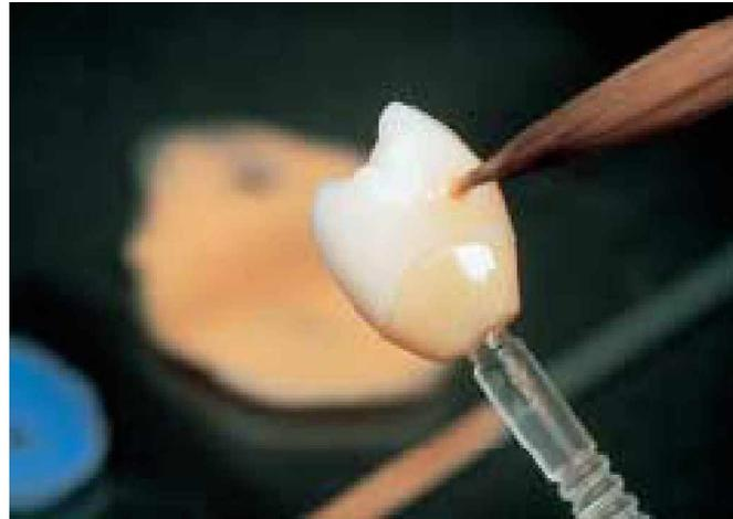
Colores más intensos se obtienen mediante la repetida aplicación de maquillaje y no aplicando capas gruesas de color. Para controlar el color, pincelar la cara interna y externa de la corona con líquido Universal de glaseado y maquillaje, volver a colocar la pieza sobre el muñón y comparar con la correspondiente guía de colores, Chromascop o A-D.
