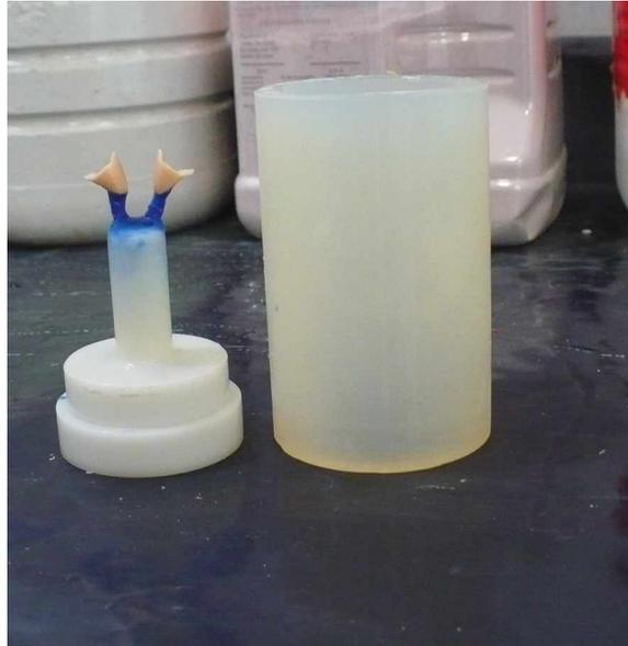
Hacemos la mezcla del revestimiento *IPS Press Vest Speed* 100g, 16ml de líquido para el revestimiento y 11 ml de agua destilada, con un tiempo de mezclado de 1 minuto.
