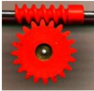
Fig. 2.13. Tornillo sin-fin y corona
