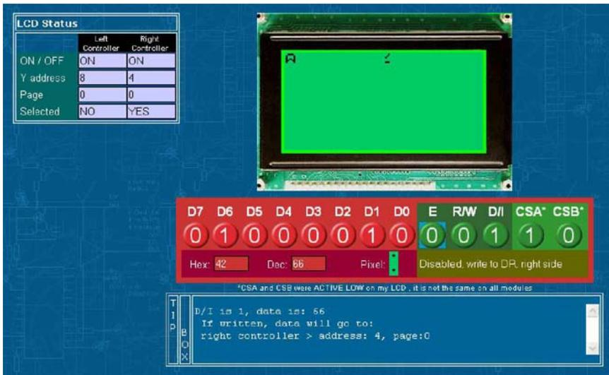
Fig. 3.19. Captura de la pantalla del software simulador del display 128x64. Nota: D6, D1, D/I y CSA están en alto.
