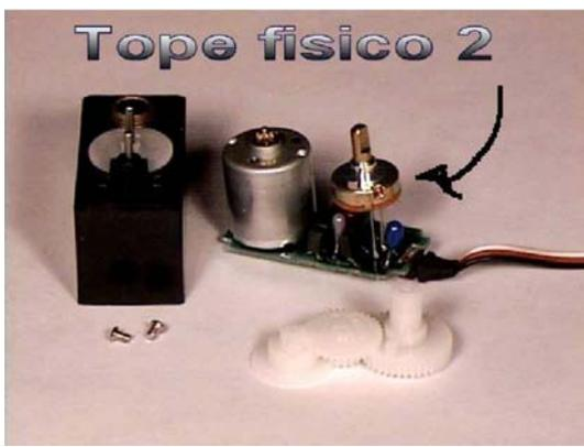
Después tenemos que quitar el potenciómetro que también limita el giro, este lo tenemos que sustituir por dos resistencias equivalentes, podemos solamente sumirlo para que no estorbe, pero para controlar mejor el servo tenemos que sustituirlo por 2 resistencias de precisión o metálicas para que no haya variaciones con respecto al otro servomotor del lado derecho que pondremos en nuestro robot.
