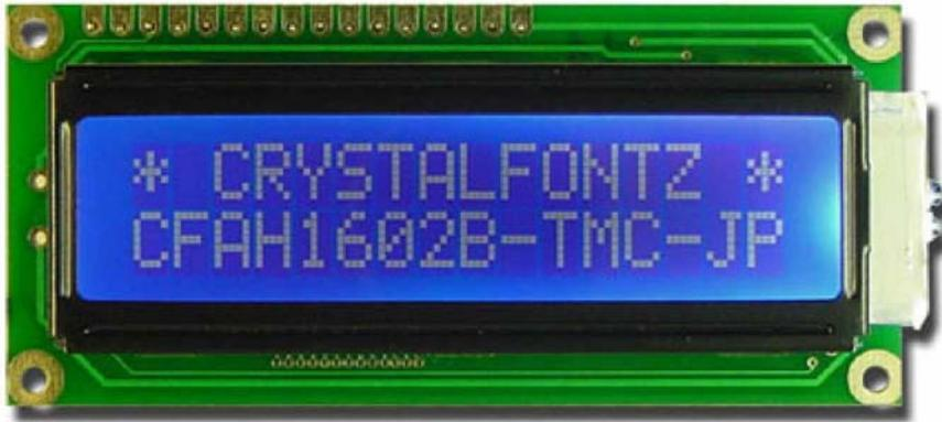
Fig. 3.1. Se muestra un display de 16 caracteres de largo por dos líneas de alto.
