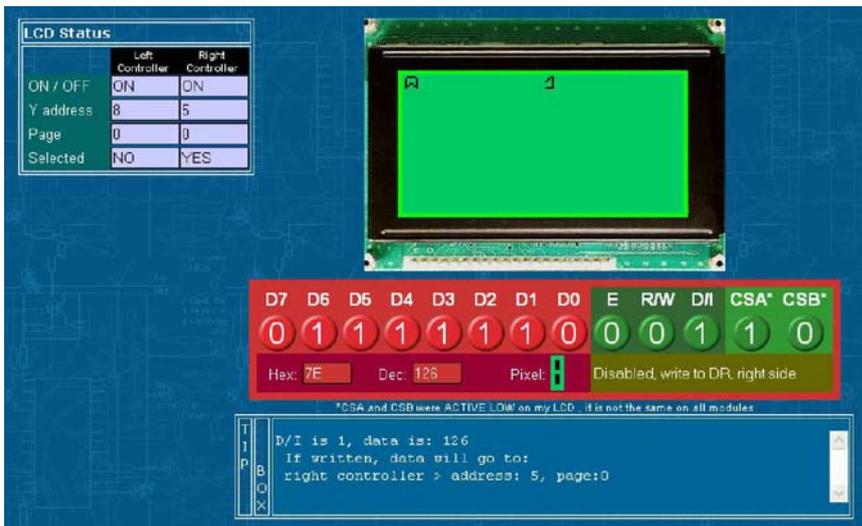
Fig. 3.20. Captura de la pantalla del software simulador del display 128x64. Nota: D6, D5, D4, D3, D2, D1, D/I y CSA están en alto.
