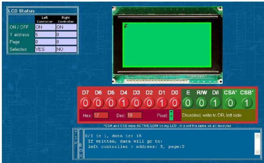
Fig. 3.12. Captura de la pantalla del software simulador del display 128x64. Nota: D4, D1, D/I y CSB están en alto.
