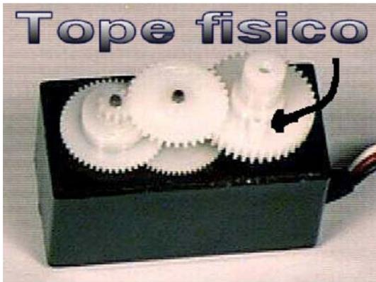
Primero tenemos que quitar el tope físico para que nuestro servo gire infinitamente, con un cutter será más que suficiente para cortar este tope. Recomiendo el servomotor 3004 aunque en la fig. 1.11 esta el 3003. Las diferencias entre estos dos son que el 3004 tiene un balero que ayuda a soportar peso que el 3003 no tiene.
