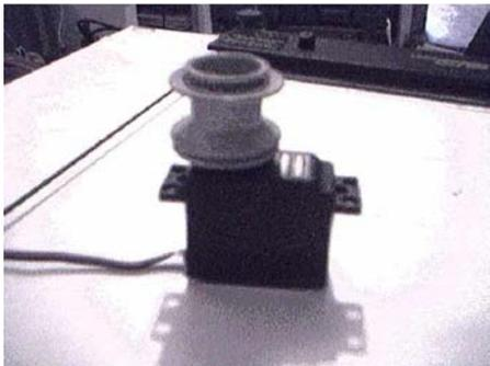
Fig. 7.6. Servomotor con rin colocado.
