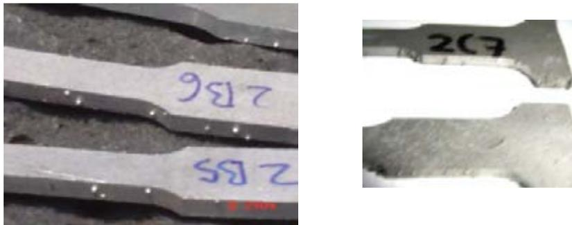
**Figuras 3.8** Lagrimeo en las probetas después del recocido.
