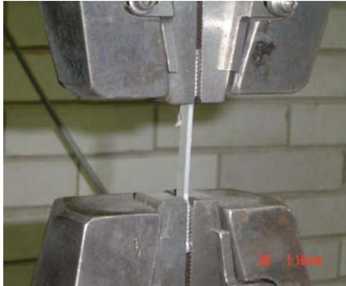
**Figura 3.9** Posición de las probetas en una prueba de tracción colocadas en la INSTRON modelo 4026.
