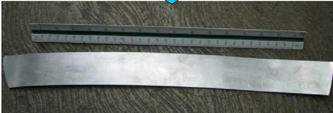
**Figura 3.3** *Lingote antes y después de la laminación a aproximadamente un 100% de deformación.*
