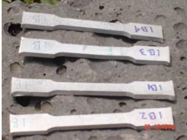
**Figura 3.6** *Probetas de tracción listas para ser sometidas a la prueba de tracción.*
