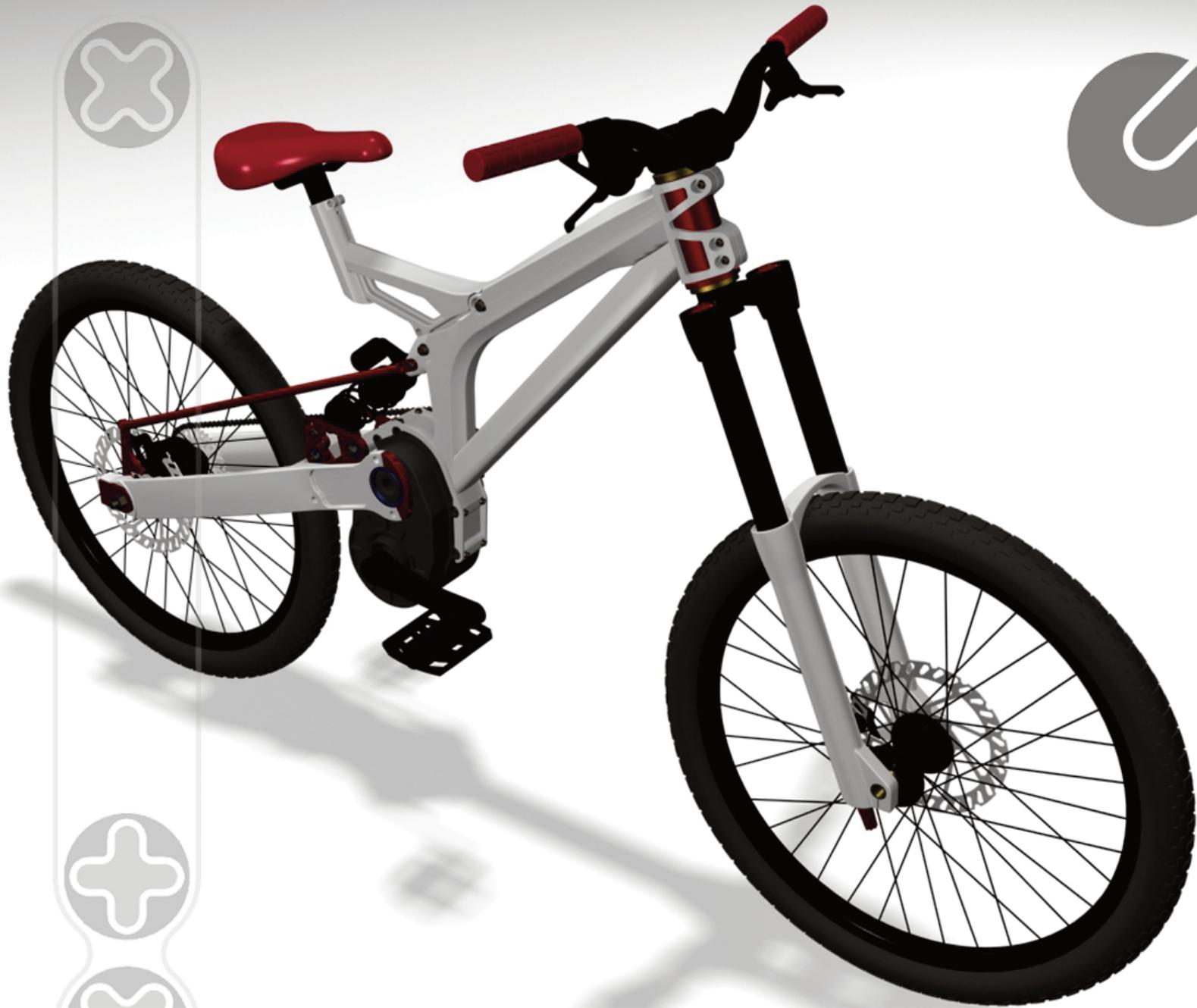
La excéntrica de la dirección, permite variar en un grado el ángulo de la horquilla, permitiendo al usuario escoger el lanzamiento de su horquilla, según el terreno, sobre el que usara la bicicleta, o por gustos de conducción.
