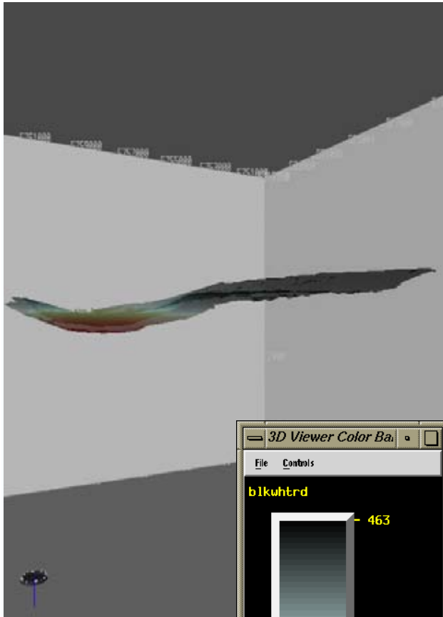
Figura 6.27. Horizonte en profundidad resultado de la interacción con el modelo DTE creado. (Landmark, Depth Team Express, 2008).
