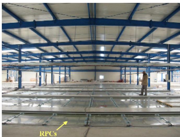
Fig.1.6. Taller del experimento ARGO. Se muestran algunas de las Placas Resistivas Contadoras.
