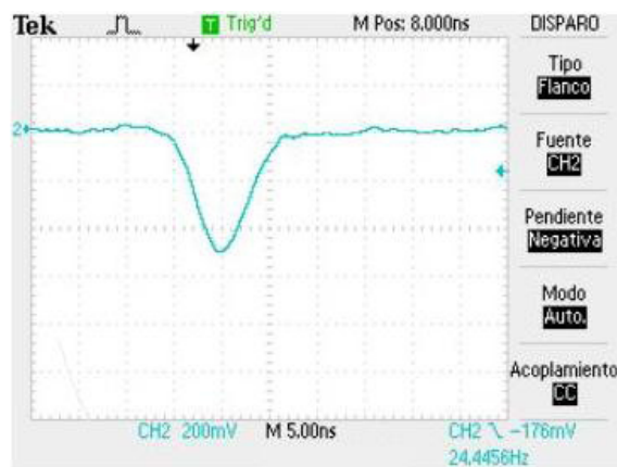
Fig. 4.12. Se muestra el pulso de la corriente oscura de uno de los fotomultiplicadores. Tiene un ancho de 7 ns, una amplitud de 450 mV, un tiempo de ascenso de 5 ns y un tiempo de descenso de 5 ns.
