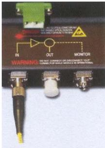
Paso 3: Conecte el otro extremo de la fibra al conector o adaptador del conector o backplane a ser medido.
