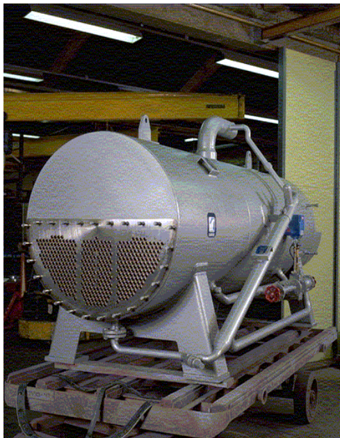
Figura 33. Intercambiador de calor intermedio (de casco y tubo) empleado como evaporador/condensador en cascada \text{NH}_3/\text{CO}_2 ( York International Corporation, 1998 ).
