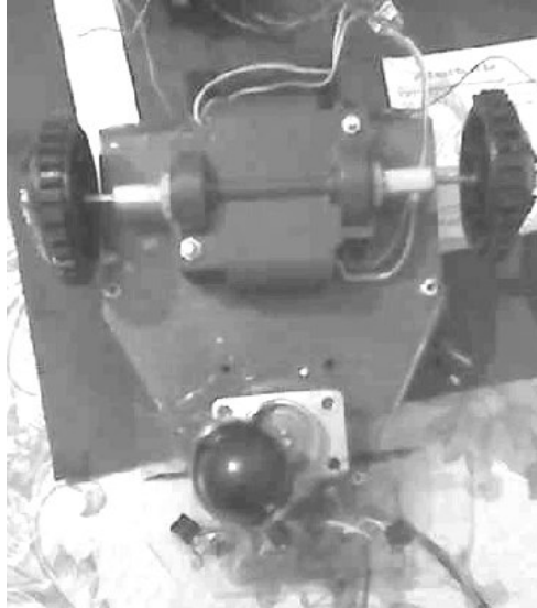
Figura 57. Montaje de caja reductora
