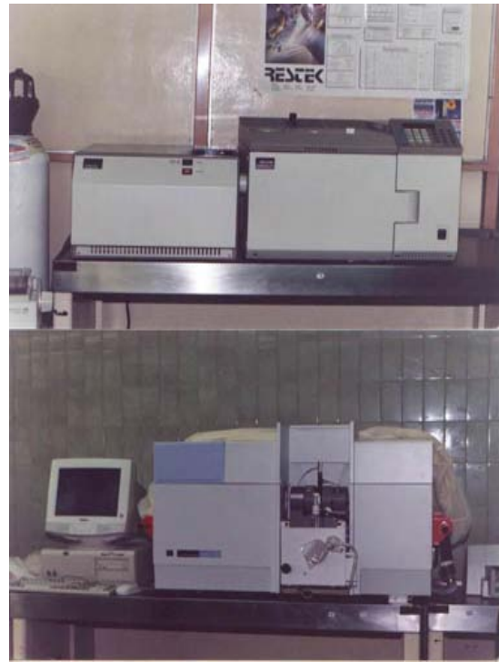
Foto 5.29. SEMEFO del D.F. 2001 Cromatógrafo de gases acoplado a espectroscopia de masas (CG-SM); y Cromatógrafo de Líquidos de Alta Resolución (HPLC)
