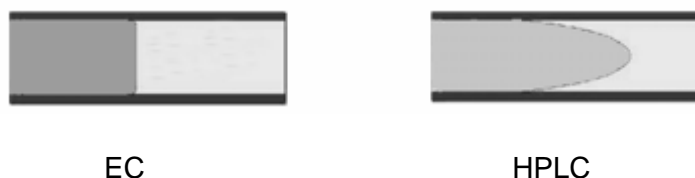
Fig. 5 Comparación de perfiles de flujo electroosmótico en EC y HPLC.
