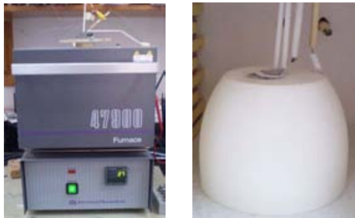
Figura III.7 Mufla Barnstead Thermolyne 47900 Furnace y el montaje del disco con los electrodos y el termopar dentro de la mufla
