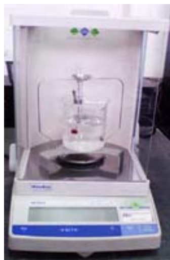
Figura III.3 balanza Mettler Toledo AB104-S con los aditamentos para ser usada como picnómetro
